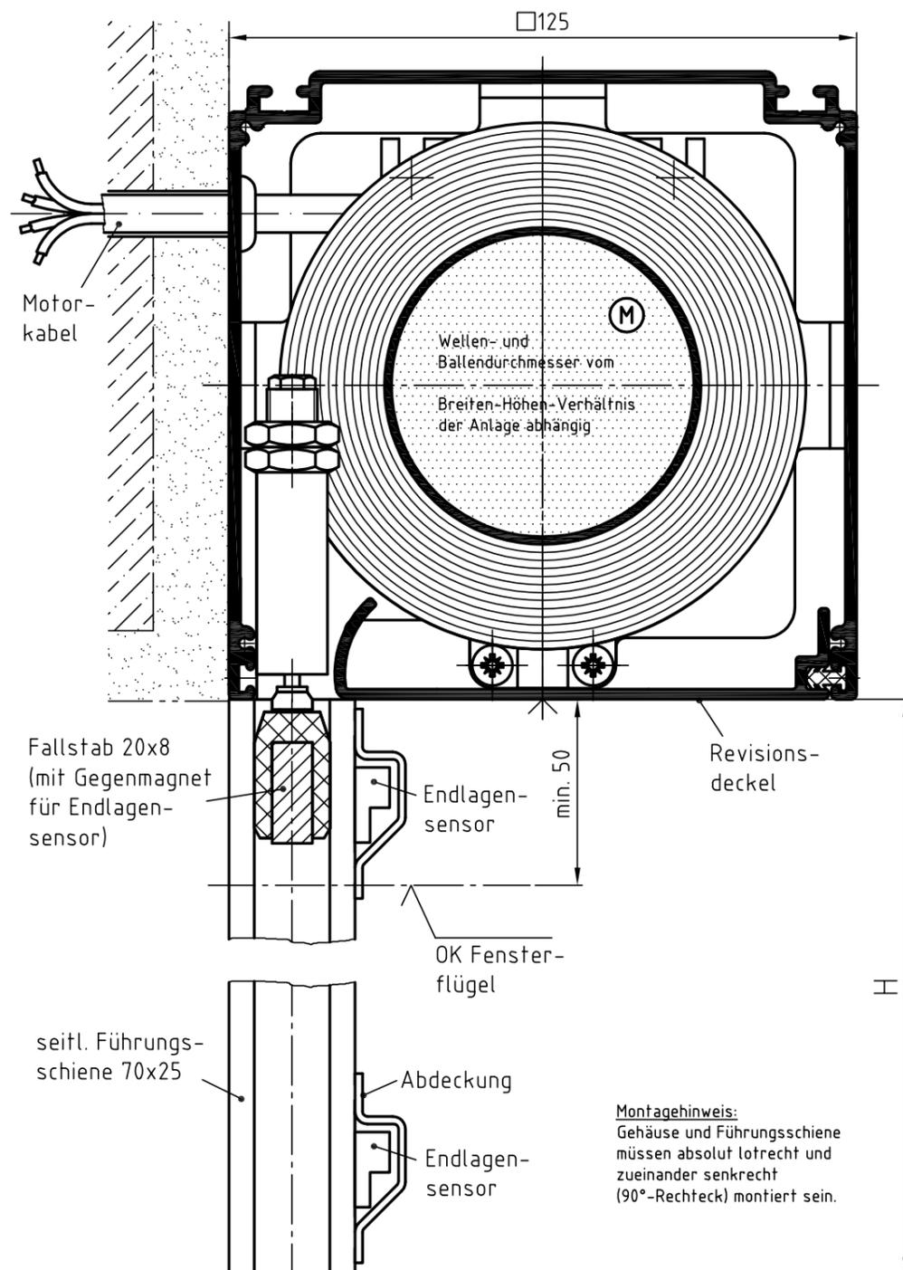
Zeichnung R2-E-MQ 125 – Längsschnitt Systemskizze | ohne Maßstab | sämtliche Angaben in mm
