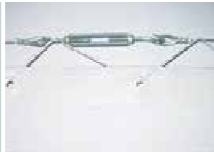
Spannseil und Spannvorrichtung für stufenlose Behangspannung und Justierung (Ansicht Rückseite).
