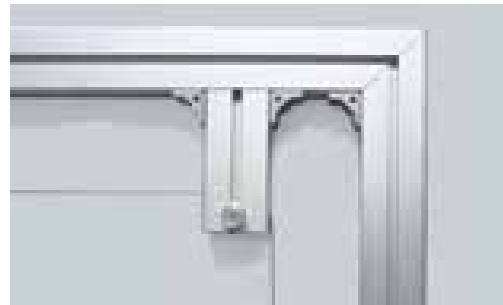
Massiver Rahmen aus stranggepressten Nutenrohren, 80 x 40 x 3 mm. Nach DIN 17615 hergestellt und über Aluminiumguss-Winkel ausgesteift (Ansicht Rückseite).
